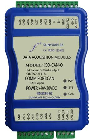
选型举例 1: 型号: ISO CAN-08-O1 表示 8 路 4-20mA 信号输出
